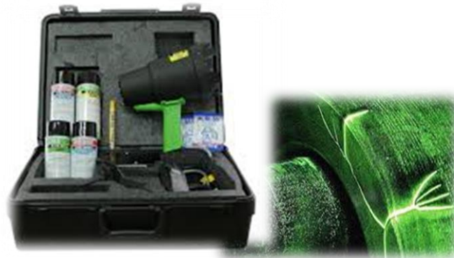
Líquidos penetrantes Tipo fluorescente
